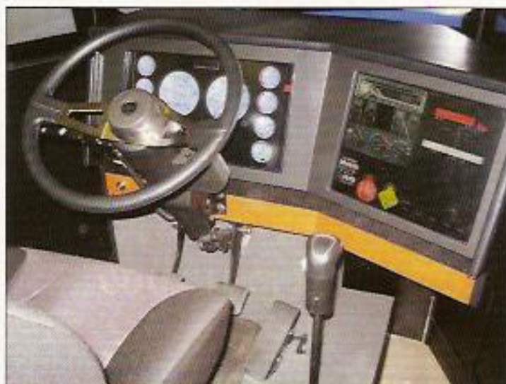
Le tableau de bord est entièrement informatisé et permet à son utilisateur de choisir son moteur et sa configuration de puissance (avec le son du moteur approprié) et de régler pour rendre l'expérience la plus proche possible de la réalité. La transmission manuelle est une fuller de Eaton. Une vraie transmission !
